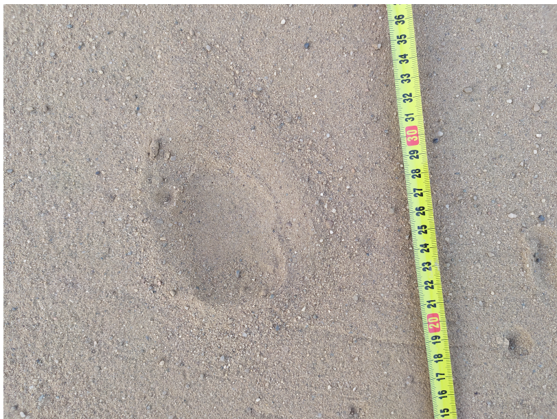
Obr. 7: Kráter od kameňa 7 po vypustení z výšky 120 cm.
