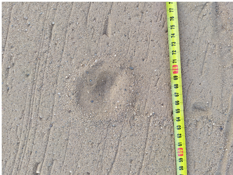
Obr. 8: Kráter od kameňa 4 po vypustení z výšky 80 cm.
