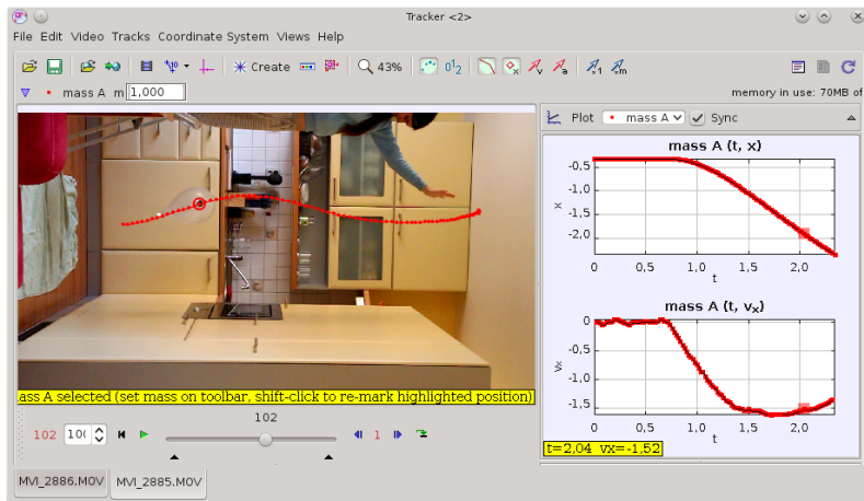
Obr. 23: Práce v programu Tracker. Po označení dostatečně kontrastního bodu (v našem případě černá značka na bílém balóнку) program pohyb tohoto bodu během záznamu vyhledá.
