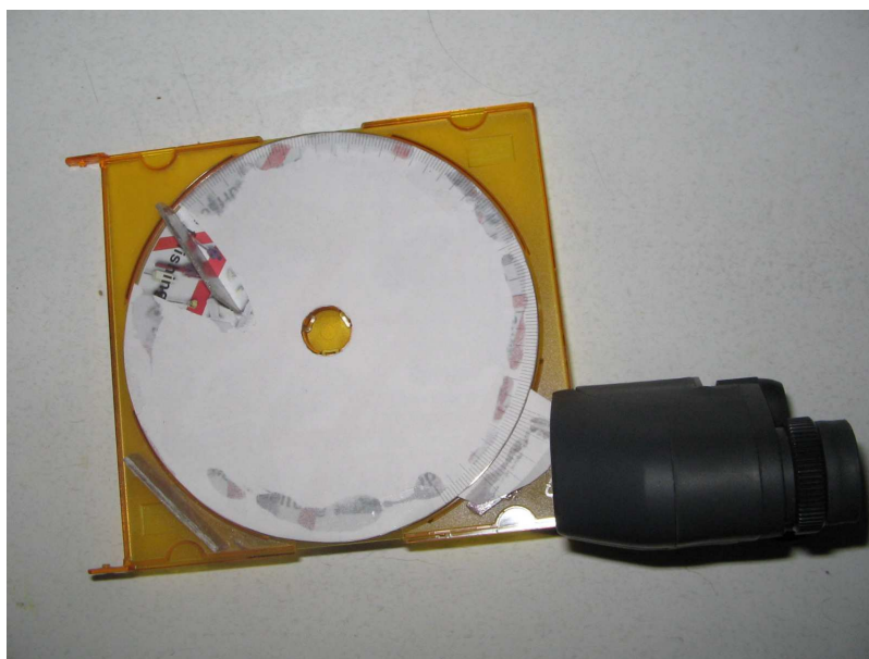
Obr. 33. Konstrukce sextantu ze dvou CD
